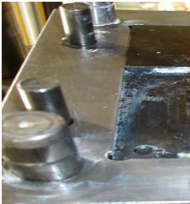
Figura 3.5. En la figura se observan los pernos de retorno, así como los pernos guía.
