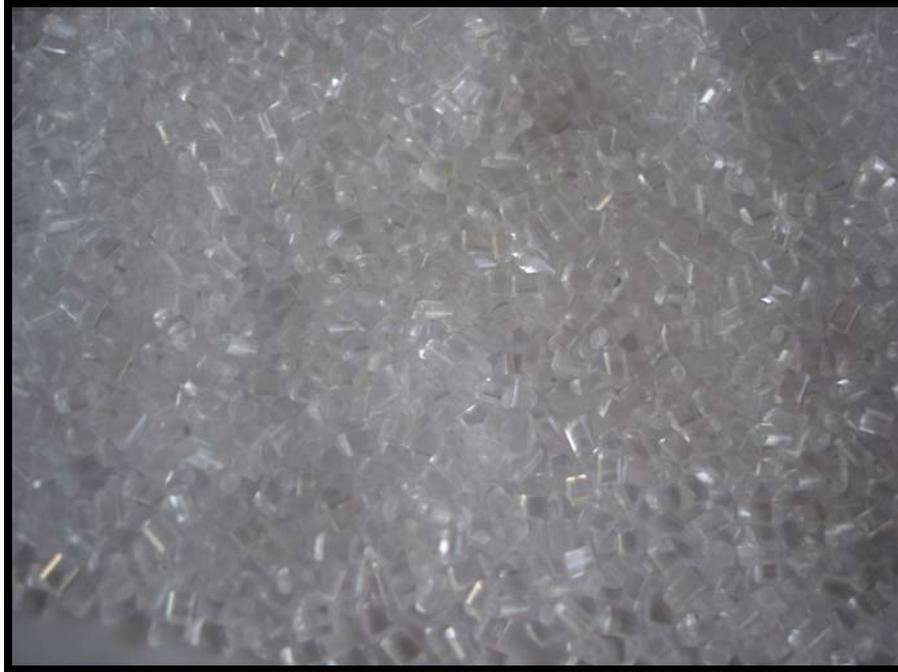
Figura 2.11. Se muestran pellets de poliestireno cristal HF-777 de RESIRENE.
