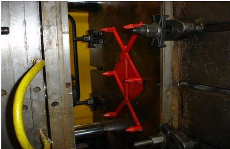
Figura 3.18. Molde de inyección mixta de 6 cavidades
