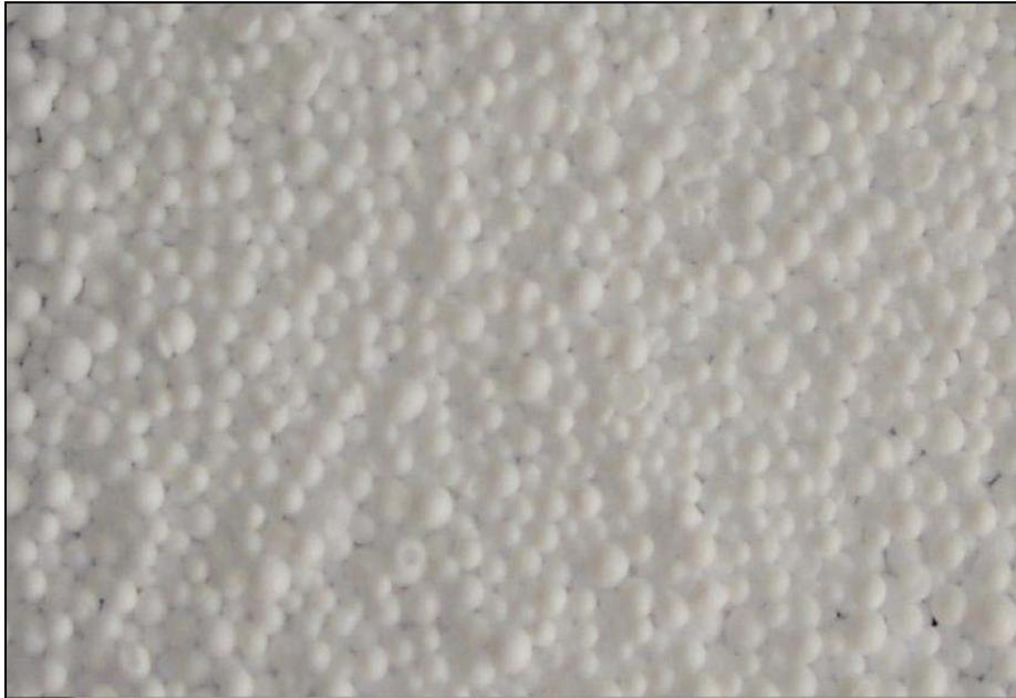
Figura 2.9. Se muestran pellets de polipropileno homopolímero HS013 de VALTEC.
