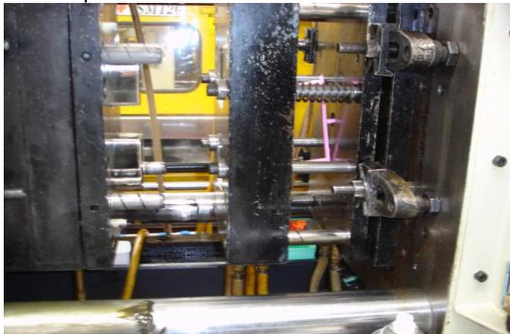
Figura 3.12. Molde de inyección de tres placas.
