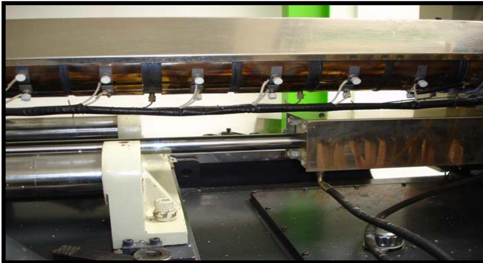
Figura 1.17. Bandas calefactores del cilindro de plastificación.
