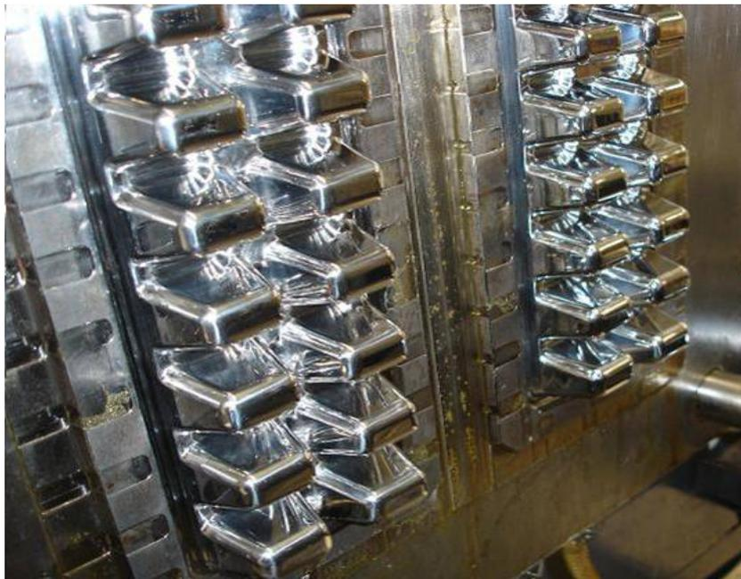
Figura 3.20. Acabado superficial tipo espejo, con la utilización de pastas diamantadas.
