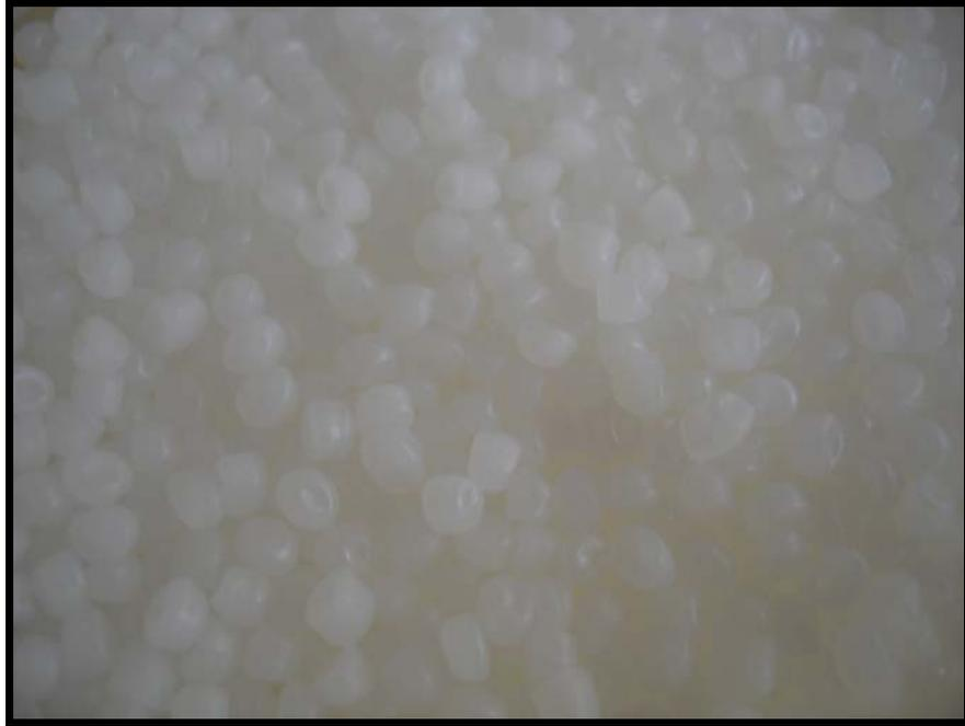
Figura 2.13. Se muestran pellets de polietileno NA 870-252 de EQUSTAR
