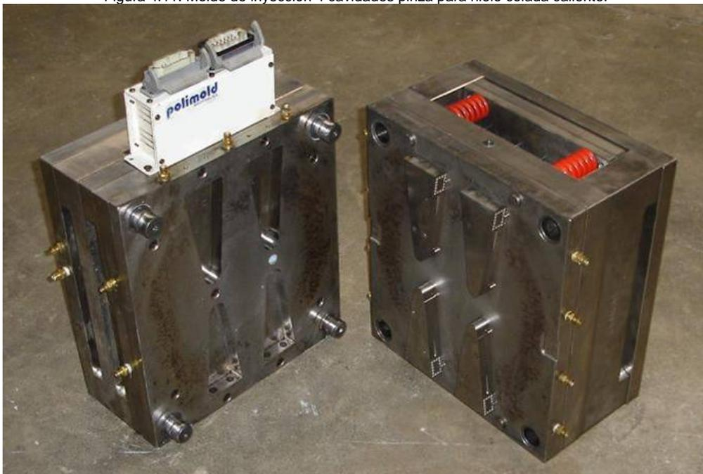
Figura 4.12. Cavidades y corazones de inyección molde pinza para hielo.
