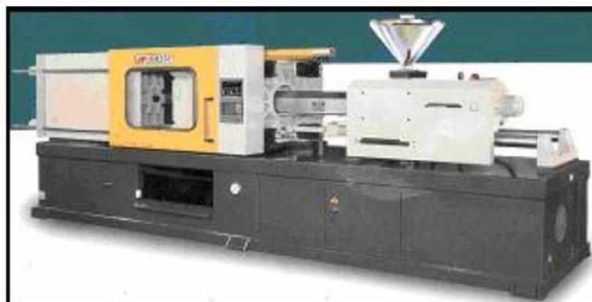
Figura 1.1 Maquina de inyección Asian Plastic
