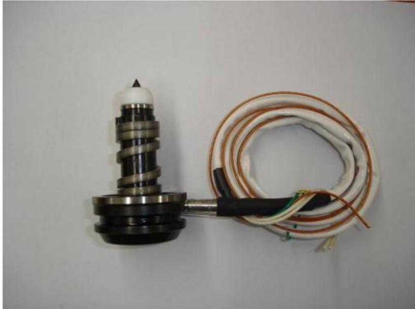
Figura 3.35. Inyector de inyección y resistencia espiral.
